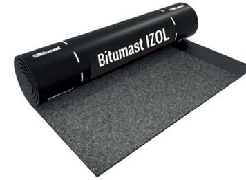
Рулонный битумно-полимерный СБС-модифицированный материал на нетканой основе из высокопрочной стеклоткани с крупнозернистой посыпкой на верхней стороне полотна. С нижней стороны материал имеет наплавляемый слой с продольным рифлением по технологии «защитный профиль».
