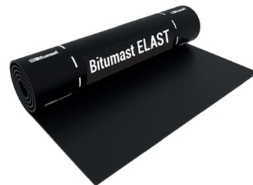
Рулонный битумно-полимерный СБС-модифицированный материал на нетканой основе из высокопрочного полиэстера с легкосгораемой полиэтиленовой пленкой на верхней стороне полотна. С нижней стороны материал имеет наплавляемый слой с продольным рифлением по технологии «защитный профиль».
