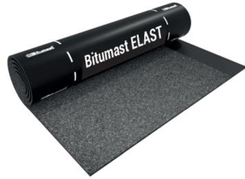
Рулонный битумно-полимерный СБС-модифицированный материал на нетканой основе из высокопрочного полиэстера с крупнозернистой посыпкой на верхней стороне полотна. С нижней стороны материал имеет наплавляемый слой с продольным рифлением по технологии «защитный профиль».
