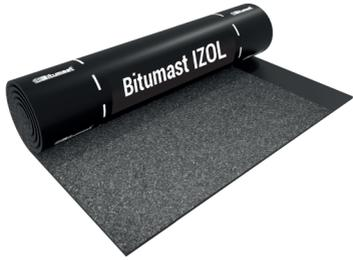
Рулонный битумно-полимерный СБС-модифицированный материал на нетканой основе из высокопрочного стеклохолста с крупнозернистой посыпкой на верхней стороне полотна. С нижней стороны материал имеет наплавляемый слой с продольным рифлением по технологии «защитный профиль».
