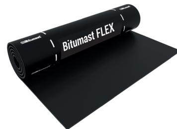
Рулонный битумно-полимерный СБС-модифицированный материал на нетканой основе из стеклохолста с легкосгораемой полиэтиленовой пленкой на верхней стороне полотна. С нижней стороны материал имеет наплавляемый слой с продольным рифлением по технологии «защитный профиль».
