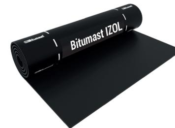
Рулонный битумно-полимерный СБС-модифицированный материал на нетканой основе из высокопрочной стеклоткани с легкосгораемой полиэтиленовой пленкой на верхней стороне полотна. С нижней стороны материал имеет наплавляемый слой с продольным рифлением по технологии «защитный профиль».
