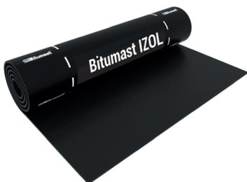
Рулонный битумно-полимерный СБС-модифицированный материал на нетканой основе из высокопрочного стеклохолста с легкогораемой полиэтиленовой пленкой на верхней стороне полотна. С нижней стороны материал имеет наплавляемый слой с продольным рифлением по технологии «защитный профиль».
