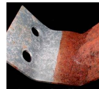
Применяются для очистки металлических поверхностей от ржавчины. Преобразователи ржавчины производят восстановление окислов железа до металлического состояния и создают на поверхности фосфатную пленку, которая является ингибитором коррозии, и замедляет процессы образования подпленочной коррозии после последующего окрашивания.
