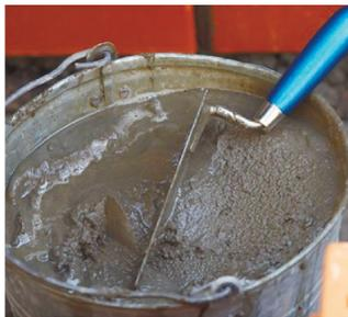
Жидкое стекло предназначено для склеивания и связки различных строительных материалов, закрепления фундаментов различных сооружений от грунтовых вод, для склеивания и пропитки бумаги и картона, а также стеклянных и фарфоровых изделий. Также используется в качестве добавки к цементным растворам при гидроизоляции полов, стен и перекрытий подвальных помещений.
